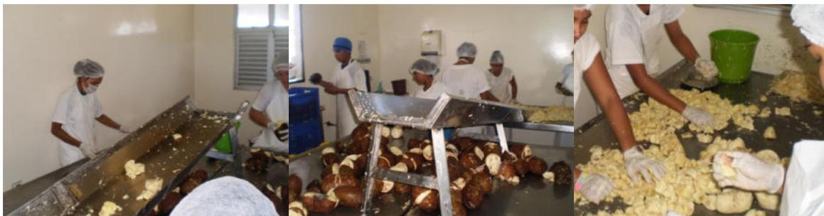
Figura 23: Esteira não mecânica e separação das fibras e sementes. Itacoatiara/AM, 2012/2013.
